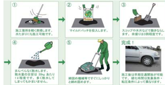
■ 「マイルドパッチ」施工手順
