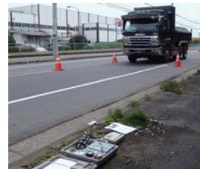
■ 「ロードサスペイブ」施工箇所の振動レベル測定
