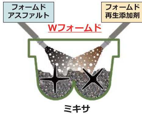
■ 「LEAB」によるアスファルト合材の製造
