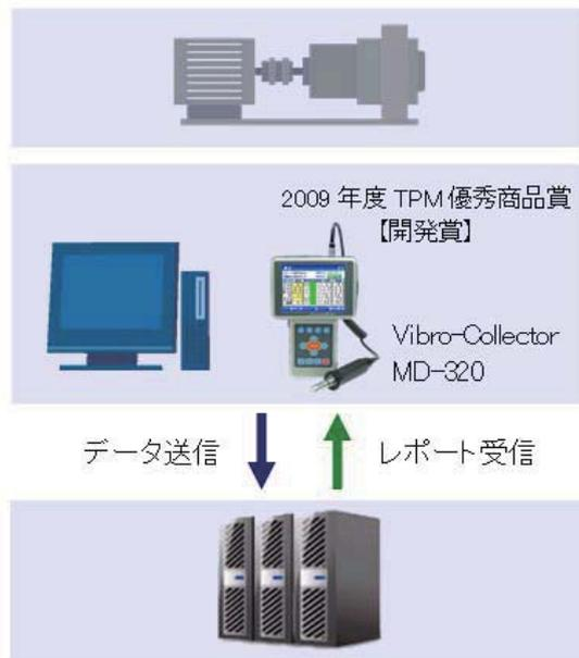
図 Web 型遠隔自動振動診断システム概要図
