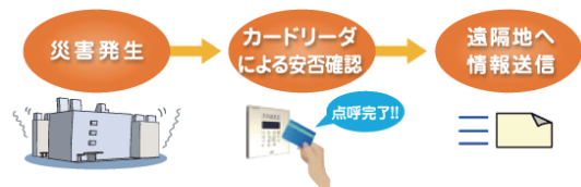
図 BCP対応入退室管理システム
