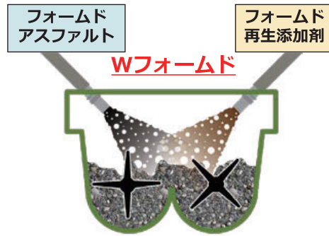
■ 「LEAB」によるアスファルト合材の製造
