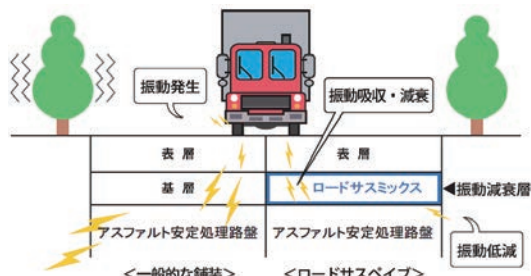
■ 「ロードサスペイブ」の振動低減メカニズム
