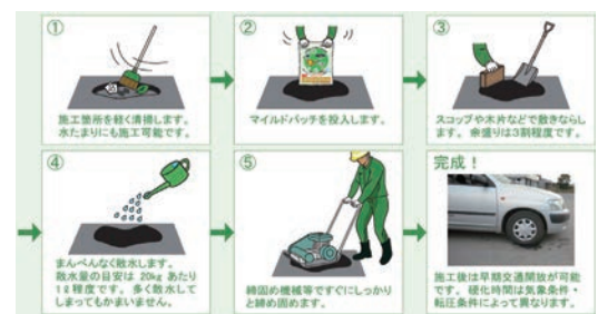
■ 「マイルドパッチ」施工手順
