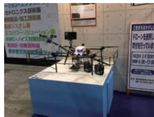
当社開発「吹付けドローン」
