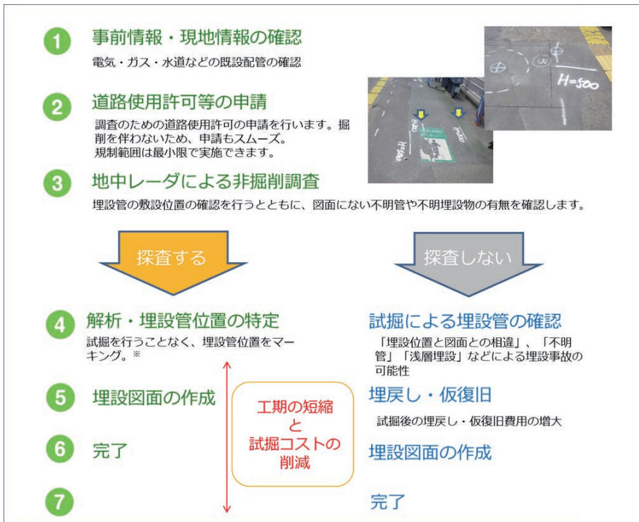
地中レーダを使用した埋設管探査のメリット
