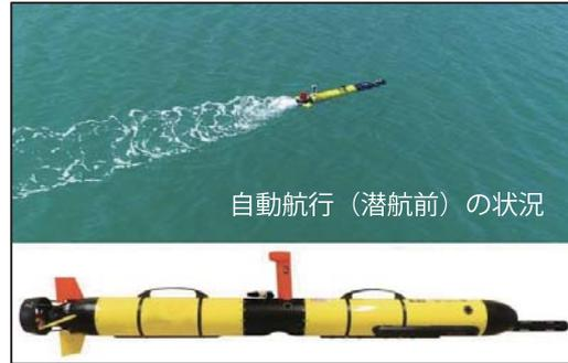
写真1 AUV (自律型無人潜水機)
